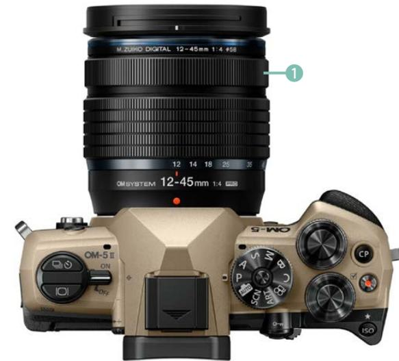
◀ Im manuellen Modus wird die Schärfe mit dem Fokussiererring am Objektiv eingestellt.
