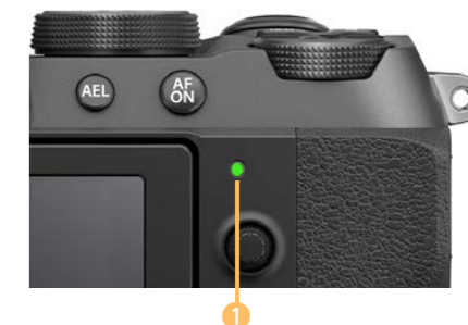
▲ Während des Akkuladens leuchtet die Kontrollleuchte.
