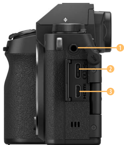
▲ Auf der linken Kameraseite gibt es drei Anschlüsse.
