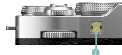
▲ Das ist das Autofokushilfslicht.
