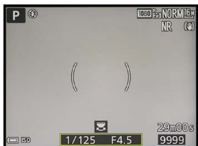
▲ Die Klammer im Bild unten kennzeichnet den Bereich, in dem die Belichtung gemessen wird.
