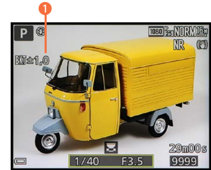
▲ Auf dem Monitor wird mit dem markierten Eintrag angezeigt, wenn eine Belichtungsreihe eingestellt wurde.
