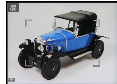
◀ Nach Drücken der OK -Taste kann das Fokussmessfeld verschoben werden.
