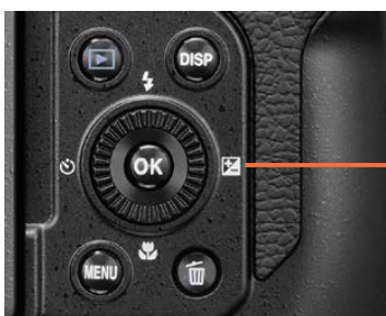
▲ Drücken Sie den Multifunktionswähler rechts, wenn Sie eine Belichtungskorrektur einstellen wollen.
