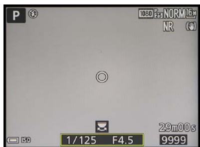
▲ Bei der Spotmessung erfolgt die Belichtungsmessung im Kreis in der Bildmitte.
