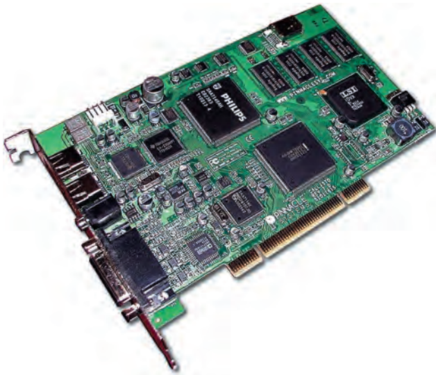
Bild 1.1 Die Videoschnittkarte aus dem Paket Studio DeLuxe von Pinnacle Systems
