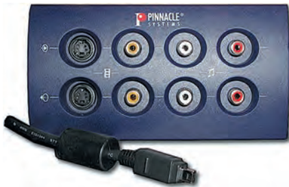
Bild 1.2 Die Anschlussbox mit separatem Firewire-Kabel
