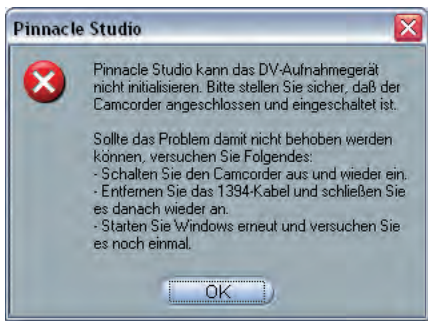
Bild 2.8 Hinweis auf einen fehlerhaften Anschluss
