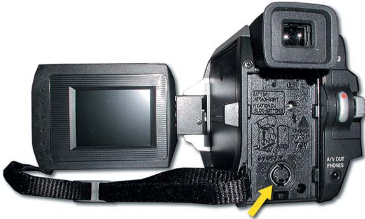
Bild 3.9 Ein SVHS-Ein-/Ausgang bei der Panasonic NV-DS30EG
