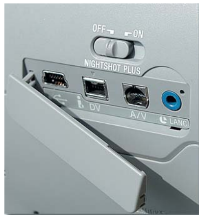
Bild 1.44 Die Ein- und Ausgänge beim Sony-Camcorder
