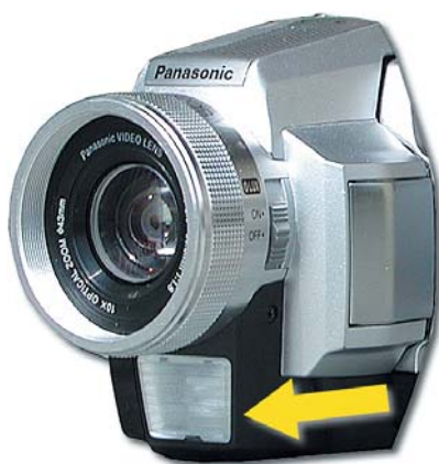
Bild 1.29 Der eingebaute Strahler
