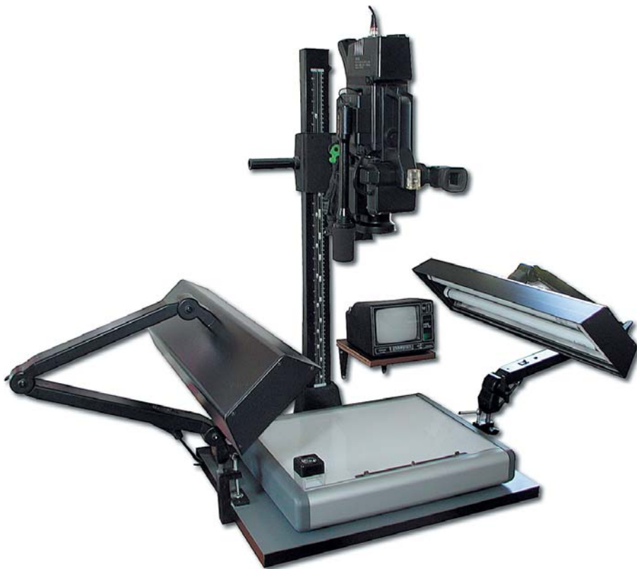
Bild 1.31 Eine Reproeinrichtung mit Auf- und Durchlichteinheit
