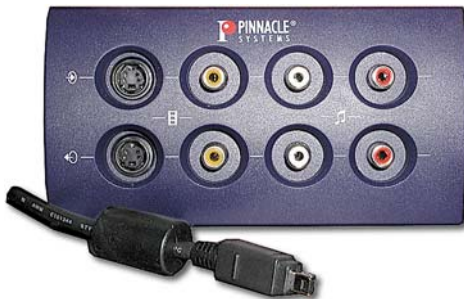
Bild 3.7 Die Anschlussbox mit dem separaten Firewire-Kabel
