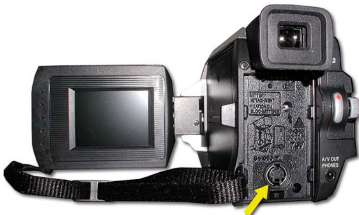
Bild 3.9 Ein SVHS-Ein-/Ausgang bei der Panasonic NV-DS30EG
