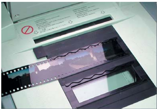
Bild 4.2 Die Halterung für einen Filmstreifen
