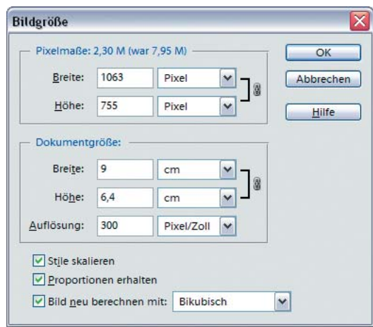
Bild 6.61 Einstellen der neuen Bildgröße
