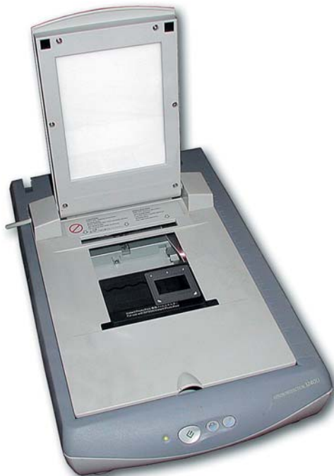
Bild 4.1 Ein Scanner mit einer Durchlichteinheit
