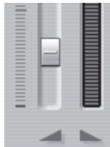
Bild 8.18: In der Mitte der Über- blendung ist die halbe Lautstärke eingestellt.
