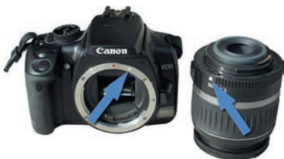
Abbildung 1.11: Markierungspunkte zum Ansetzen des Objektivs
