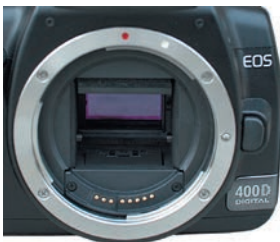
Abbildung 6.18: Der CMOS-Sensor wird sichtbar.
