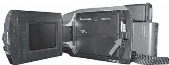
1.18 Der Firewire-Anschluss des Camcorders
