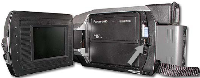
Bild 1.18 Der Firewire-Anschluss des Camcorders
