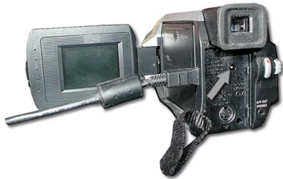
Bild 2.21 Der Netzteilanschluss des Camcorders
